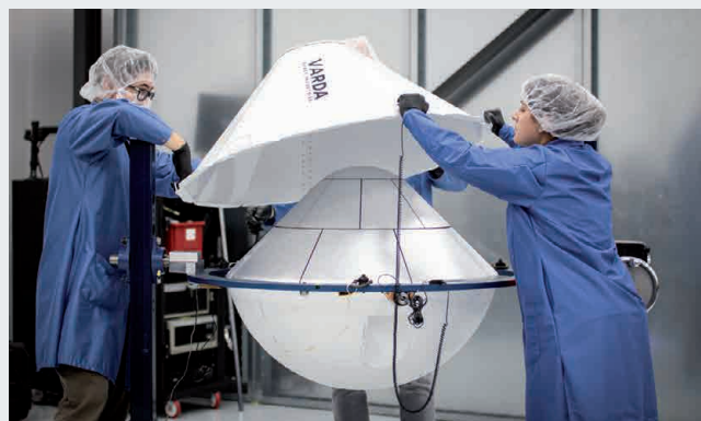
La nave W-5 de Varda integra una plataforma satelital propia, una cápsula de reentrada y un módulo de procesamiento farmacéutico adaptado para operar en las condiciones de microgravedad del espacio.
