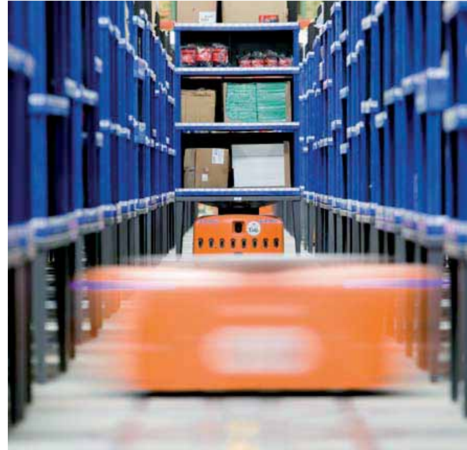
Un sofisticado software "da vida" a estos robots que permiten gestionar la logística de grandes almacenes de mercancías con una extraordinaria rapidez. El sistema, de Kiva Systems, está ya funcionando en algunas empresas norteamericanas.
