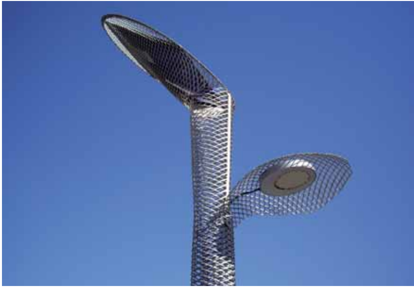
Ecofarola. La han llamado Farola viva, y es diseño de Capella García Arquitectura. El producto consta de cimentación reutilizable de hormigón reciclado, báculo de malla desplegada de acero inoxidable, equipo lumínico de 15 W (LED) y placa solar. Con el uso de una malla desplegada se ha buscado la desmaterialización del producto (se reduce la cantidad de material utilizado).
