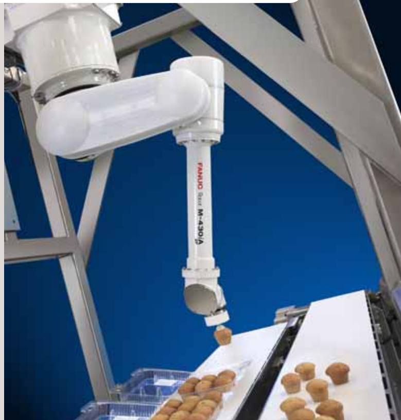
El M-430iA es un robot de manipulación, de diseño antropomórfico, de largo alcance (900 mm) y alta velocidad para el sector de alimentación. Es de Fanuc Robotics.
