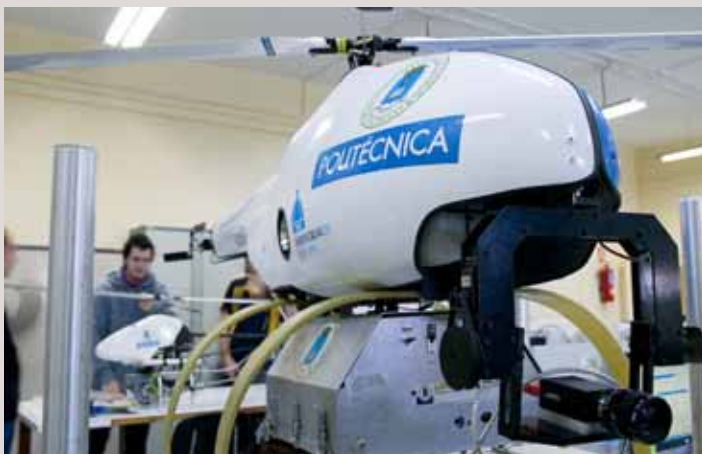
Robot aéreo, capaz de volar sin necesidad de piloto humano gracias a su sistema de control y a la información de su posición y orientación suministrada por los distintos sensores a bordo. Desarrollado por la UPM, sus aplicaciones son: seguridad y vigilancia (policía, vigilancia de fronteras, guardacostas), rescate e incendios, inspecciones de instalaciones (tuberías, tendidos eléctricos, presas...), agricultura y pesca (sembrado, regadío, bancos de pesca,...), geológicas y medioambientales (monitorización del clima, movimientos sísmicos, polución...) y comunicaciones y retrasmisión (antenas móviles, filmaciones aéreas, etc.)
