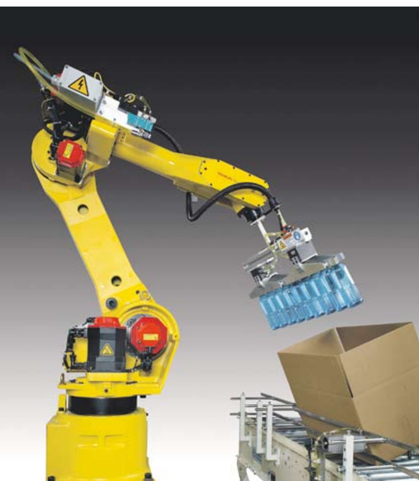
Encajado de botellas plásticas. De Fanuc.
